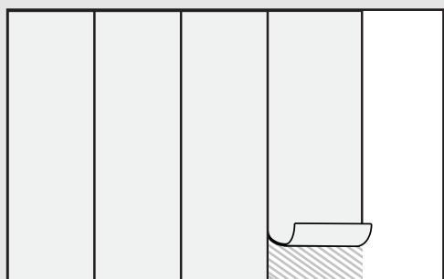
**TOP TIP:** Spojeve dodatno stisnite gumenim valjkom.
